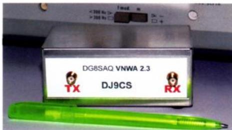
Bild 1: Aufgebauter VNWA 2.3 mit Kugelschreiber zum Größenvergleich
