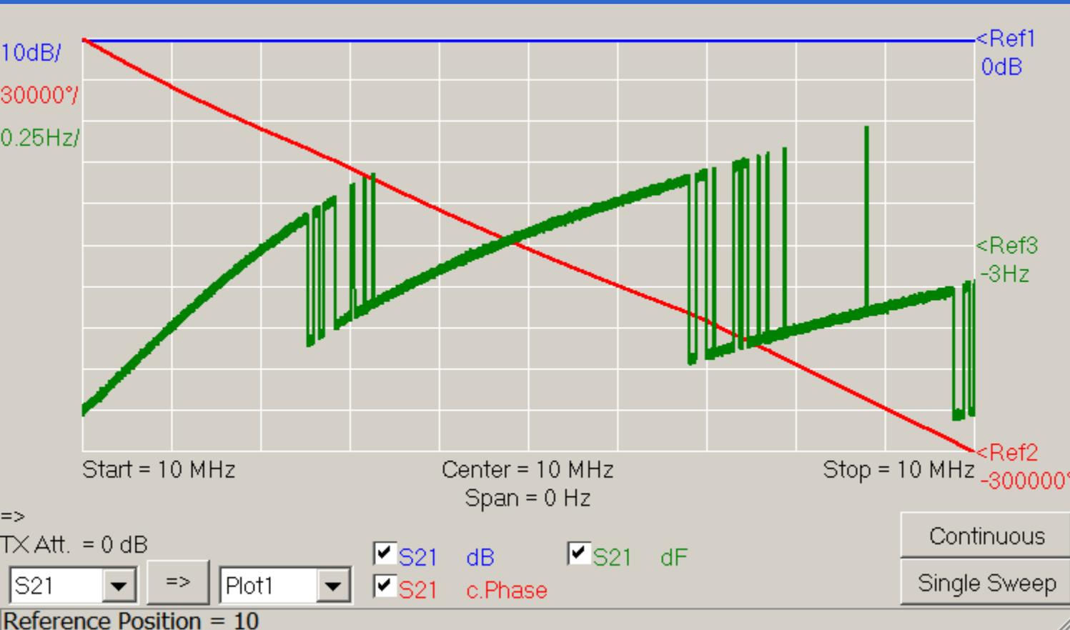
Abweichung =  $-3 \text{ Hz} \pm 1 \text{ Hz}$  bei 10 MHz  $\equiv -0,3 \text{ ppm}$
