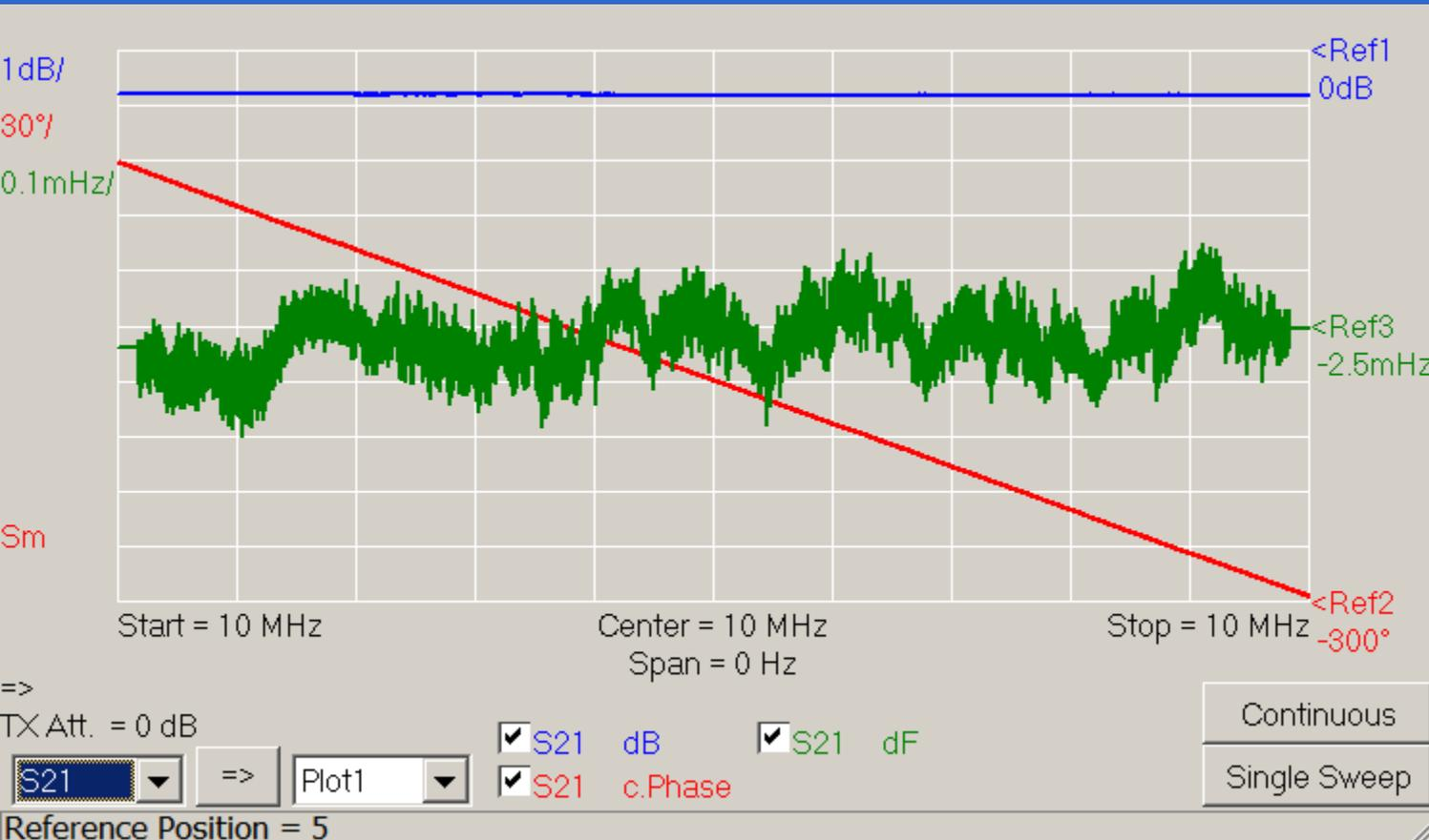
Abweichung =  $-0,0025 \text{ Hz} \pm 0,0003 \text{ Hz}$  bei 10 MHz
