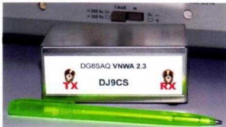
Bild 1: Aufgebauter VNWA 2.3 mit Kugelschreiber zum Größenvergleich
